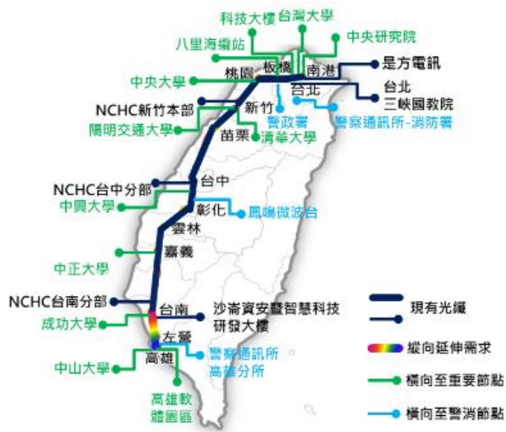
國網中心自建高鐵骨幹光纖架構示意圖 (含第一期、第二期)
