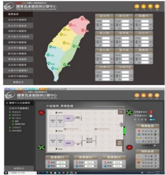
▲中繼機房環境遠端監控
